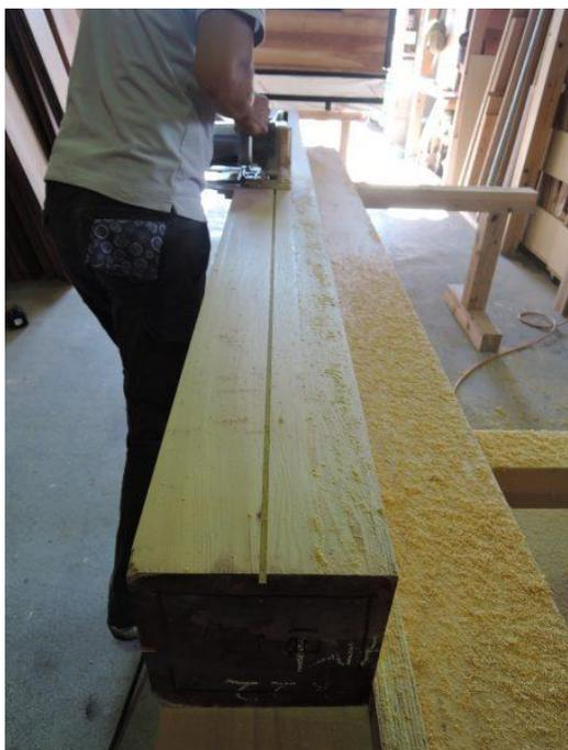
6寸の柱の真ん中に5mmの幅で深さ10mmの溝ををビシーッと真直ぐに！！
