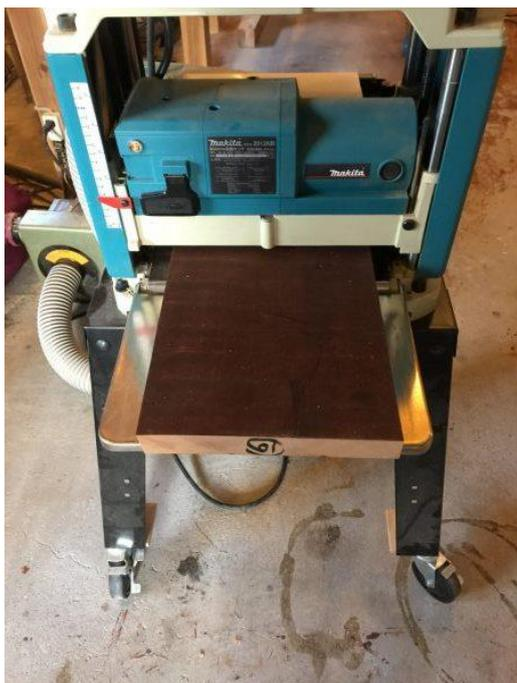
小さくしたら、作業場にあるプレーナーでも削れるので表面を仕上。
